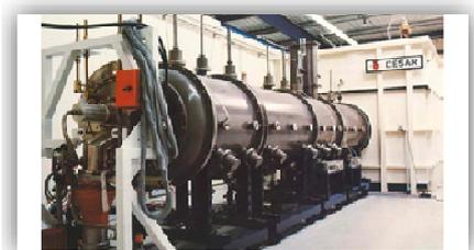
Moyen CESAR de classe méga-volts et centaines de kilo-ampères pour la génération de faisceaux d'électrons intenses
