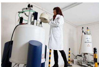
Chargement des tubes d'échantillons dans un analyseur RMN
