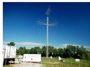
Antenne large bande pour tests électromagnétiques
