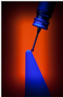
Profilométrie d'un objet fabriqué (CEA/Le Ripault)
