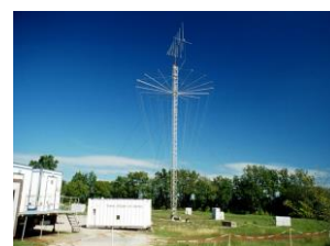
Antenne large bande pour tests électromagnétiques
