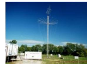
Antenne large bande pour tests électromagnétiques
