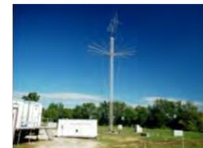
Antenne large bande pour tests électromagnétiques
