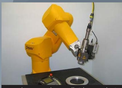
soudage par laser piloté par robot
