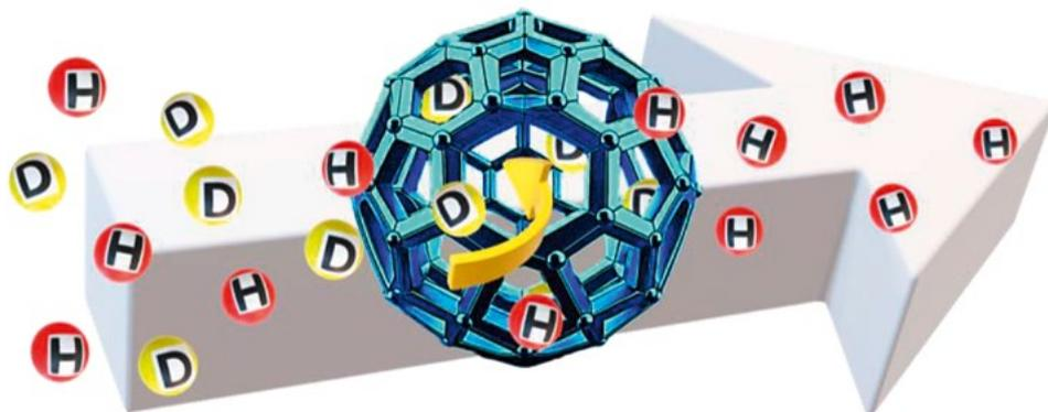
→ Schéma de principe du tamisage quantique. Les molécules de gaz (H : hydrogène, D : deutérium) sont mises au contact du tamis (zéolithe) à une température de  $-233\text{ }^{\circ}\text{C}$ . Seul le deutérium pénètre dans le matériau et s'adsorbe à la surface de la cage. L'hydrogène n'accède pas à l'intérieur et passe à côté du tamis. Dans un cas idéal, la séparation est totale.
