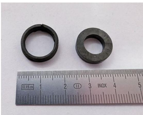
→ Photographies de tores en ferrite  $(\text{MnZn})\text{Fe}_2\text{O}_4$  mis en forme (à gauche) par impression 3D et (à droite) par pressage. L'impression 3D donne accès à des géométries inaccessibles au procédé traditionnel et conduit ici à une limitation des pertes de puissance magnétique.
