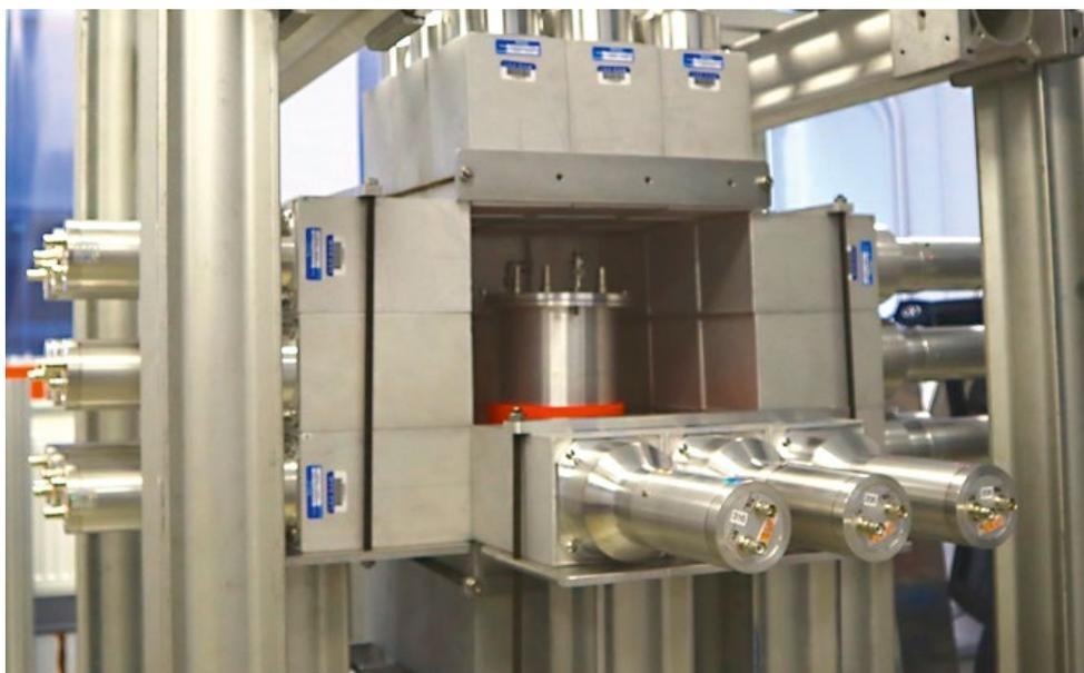
→ Photographie du dispositif expérimental utilisé dans cette étude, en cours de montage. Les 54 détecteurs de photons forment un cube, dont l'arête mesure 33 cm. Une partie de la face avant du cube n'est pas encore installée, permettant d'apercevoir l'enveloppe cylindrique de la double chambre d'ionisation. Le dépôt de californium 252 ultramine se trouve au centre de cette chambre.
