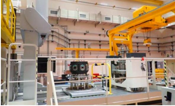
—> Machine à mesurer tridimensionnelle (MMT) du hall d'assemblage et d'intégration français équipée des deux postes d'assemblage.
