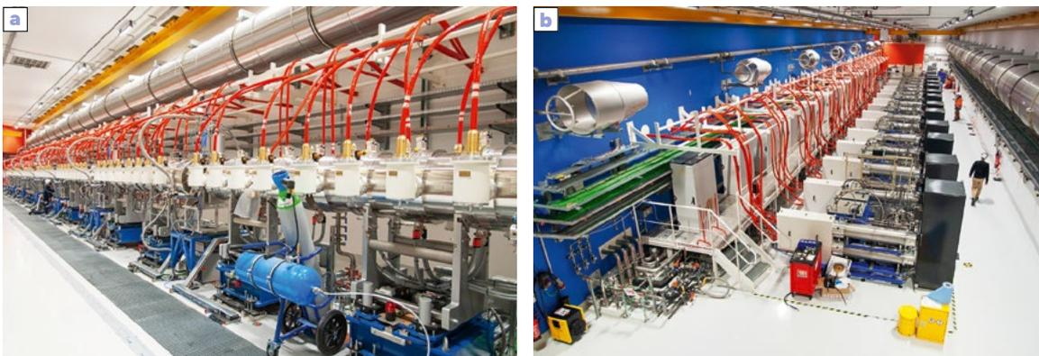
→ Photographies de [a] l'accélérateur de l'axe 3 d'Epure composé de l'injecteur et des 64 cellules accélératrices qui sont alimentées par [b] 16 générateurs à haute tension au moyen de 128 câbles à haute tension (rouge).
