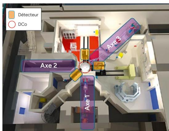
→ Représentation 3D du hall d'expérience avec identification de l'extrémité des trois sources de rayons X, les détecteurs associés et le dispositif de confinement.
