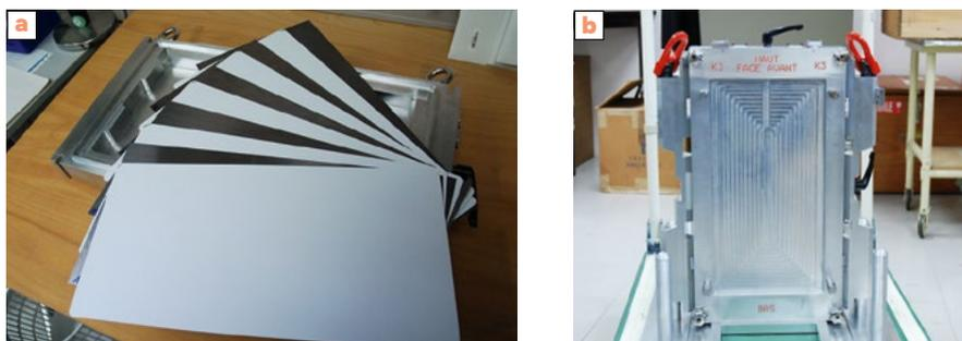
→ [a] Photographie d'un empilement d'écrans radioluminescents à mémoire constitué d'une alternance d'écrans radio en blanc et de feuilles de tantale en noir, permettant d'augmenter le pouvoir d'arrêt du détecteur. [b] Photographie du détecteur constitué et utilisé lors des expérimentations sur l'installation Epure.
