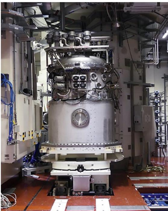
→ Dispositif de confinement en configuration deux axes dans le hall d'expérience.
