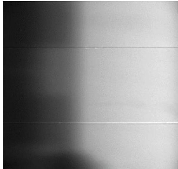
→ Image mesurée par le détecteur de l'axe 2 lors d'un flash sur l'axe 1. L'ombre de certains équipements apparaît sur l'image (zone plus sombre à gauche), ce qui rend une radiographie inexploitable.
