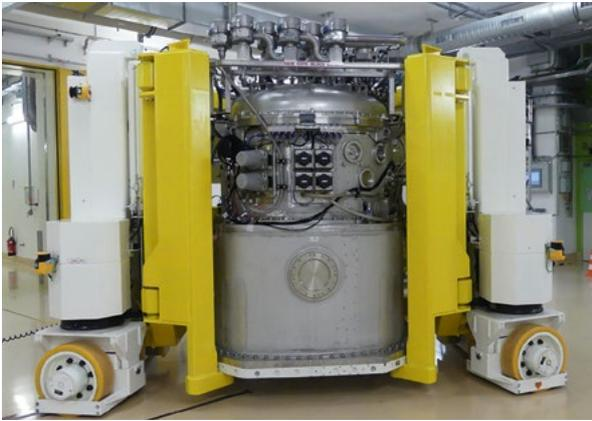
—> Système de transfert du dispositif de confinement en configuration deux axes pour son déplacement dans les couloirs de l'installation.
