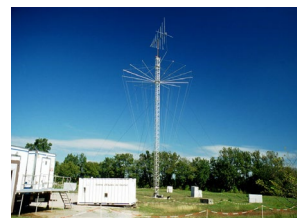
Antenne large bande pour tests électromagnétiques
