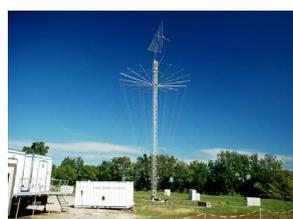
Antenne large bande pour tests électromagnétiques
