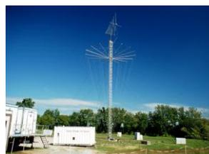
Antenne large bande pour tests électromagnétiques
