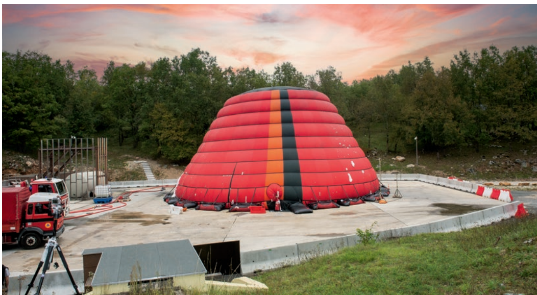
← Exercice de confinement d'explosif par cône et mousse acqueuse sur le Centre de Gramat en 2013
