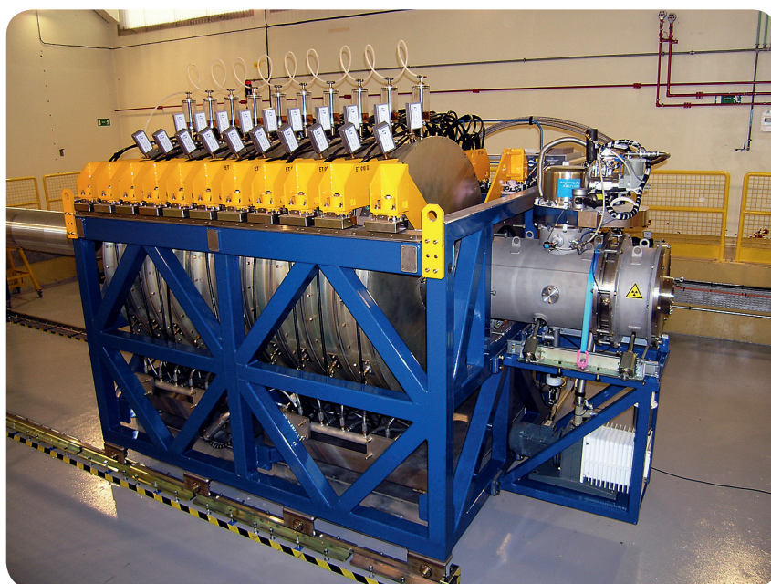
Fig. 2 : Le module LTD 1 MV au CEA-DAM. 1-MV LTD module at CEA-DAM.
